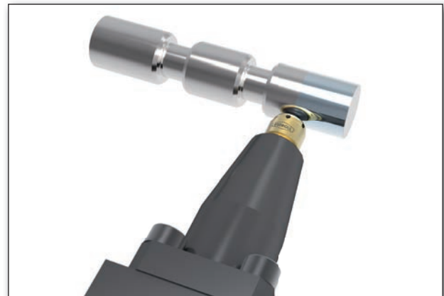
Festwalzen eines Steuerkolbens, um die Lebensdauer zu erhöhen.
