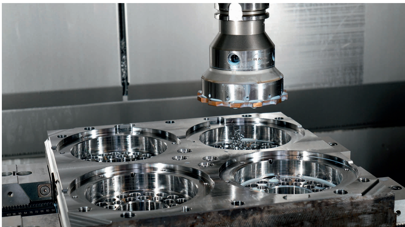
1 Ein Spannfutter-Gehäuse aus 1.2312 (40CrMnNiMo8-6-4) wird mit einem 108-mm-RX-Reibwerkzeug von URMA bearbeitet. Verlässlichkeit und Standzeit des Werkzeugs bilden die Basis für eine bedienerlose Fertigung bei Erowa (© URMA)
