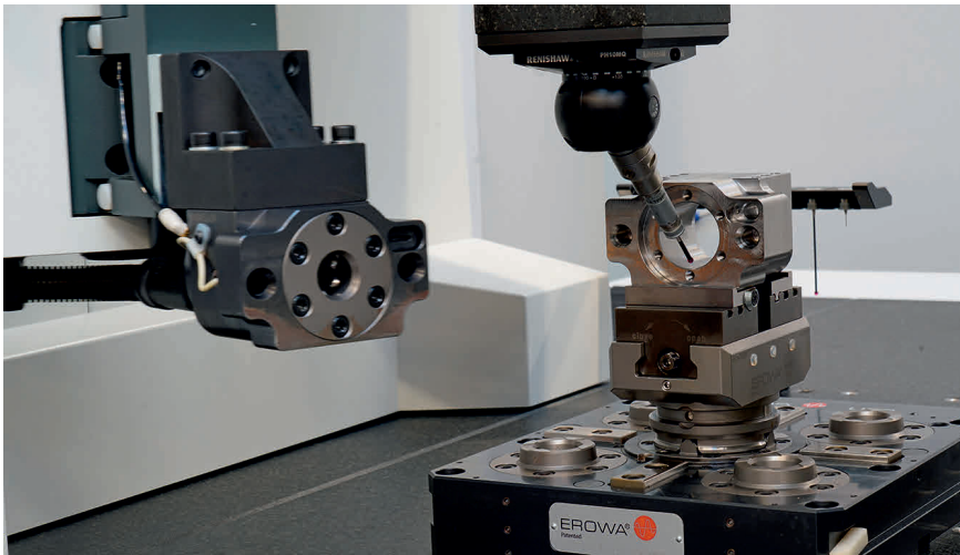
2 Ein geriebenes, hochpräzises Bauteil in der Endkontrolle auf einer Portal-Messmaschine Erowa CMM Qi (© URMA)
