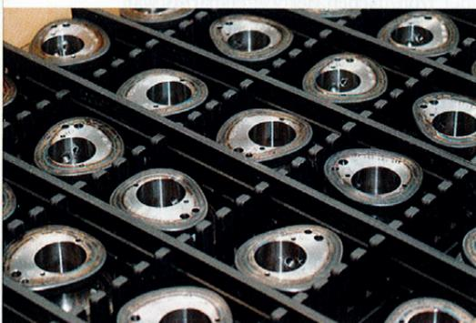
3 Auch in solche Steuerkurven – sie sind das Herzstück einer Stickmaschine – sind Präzisionsbohrungen einzubringen, bei denen die erforderliche hohe Genauigkeit zu erreichen ist (© Urma)
