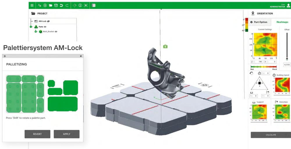
**1 Start.** Im ersten Schritt wird die gewünschte Maschine ausgewählt und die zu fertigenden Bauteile importiert. Ist Ihre Maschine bereits mit dem Paletiersystem **AM-Lock** ausgestattet? Wenn ja – auf welcher Palettenkonfiguration soll das Bauteil gedruckt werden? Sie haben die Wahl zwischen verschiedenen Layouts.
