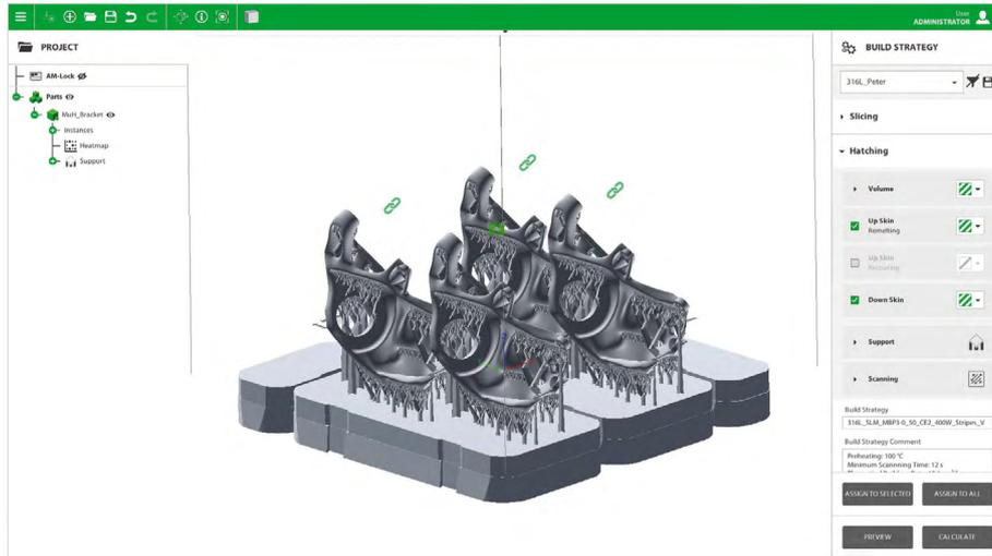
**4 Nesting.** Mehrere Instanzen (Kopien) eines Teils werden als Matrixmuster vervielfältigt. Änderungen werden über eine Mutter-Kind-Beziehung 1:1 auf die Instanzen übertragen, was identische Bauparameter garantiert.
