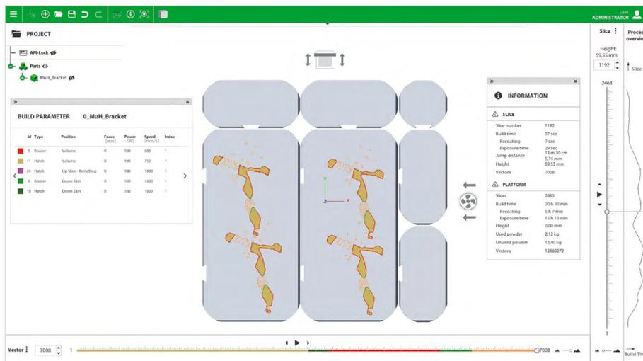
**6 Viewer.** Der letzte Schritt vor der Fertigung ist die Überprüfung der erzeugten Schichten. Die unterschiedlichen Schichtbereiche Volume, Border, Down-Skin und Up-Skin werden zur besseren Darstellung in unterschiedlichen Farben visualisiert. Nach der Verifizierung können die aufbereiteten
