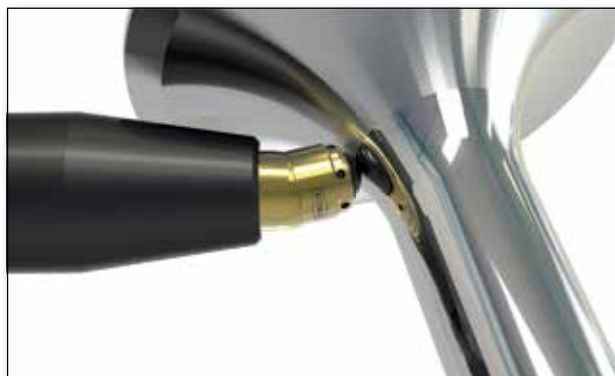
深滚压气门的柄体、弧面和平面。
