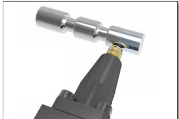
深滚压加工控制活塞以提高使用寿命。
