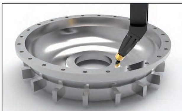
Usinage d'un carter de convertisseur avec HG13, afin d'optimiser les propriétés de glissement.
