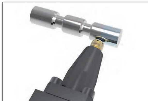
Galetage de renforcement d'un piston de commande, pour augmenter la durée de vie.
