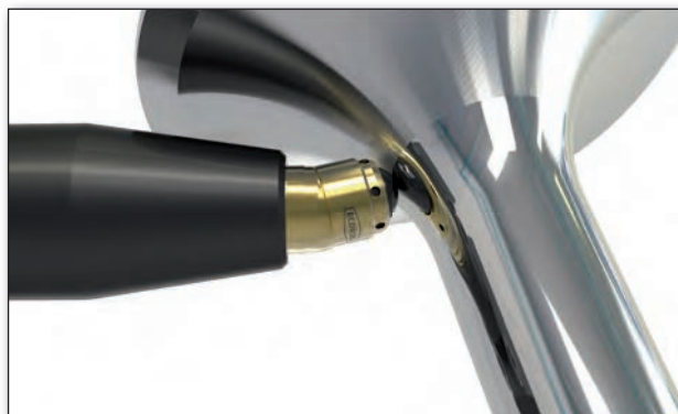
Galetage de renforcement de partie de tige inférieure, rayon et tête d'une soupape
