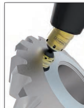
Galetage de la zone sphérique d'un pignon conique.
