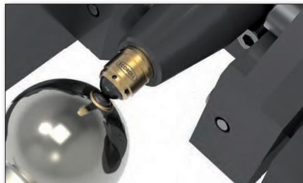
Galetage d'une articulation sphéroïde
