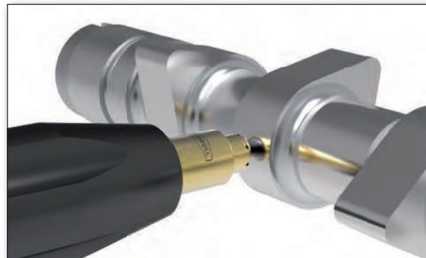
Galetage dur d'un arbre à cames
