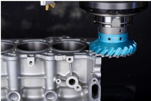
Grâce à la rigidité élevée de l'outil du MX diamond, le dégrossissage et la finition sont possibles avec le même tranchant.
