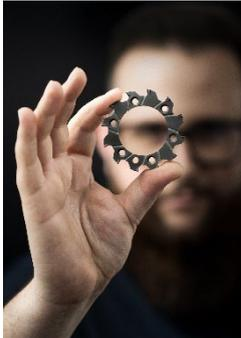
L'outil de fraisage à pointe diamantée peut être utilisé pour l'usinage des métaux non ferreux.
