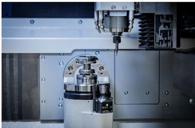
Le centre de micro-usinage microone convient parfaitement à la fabrication de composants d'horlogerie et de boîtiers. Outre l'industrie horlogère, il existe des applications dans la technologie médicale sur l'usinage de micropièces.
