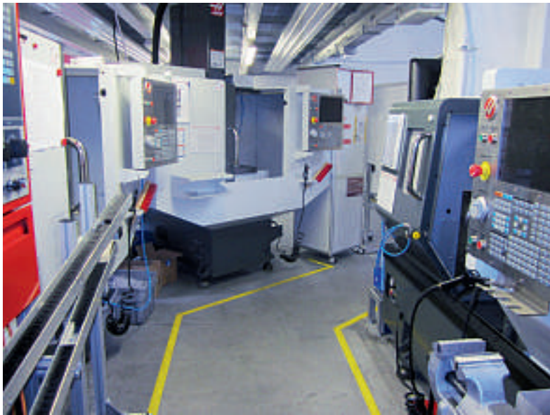
Wirtschaftlich arbeitende Bearbeitungszelle, bestehend aus sechs kostengünstigen CNC-Werkzeugmaschinen.
