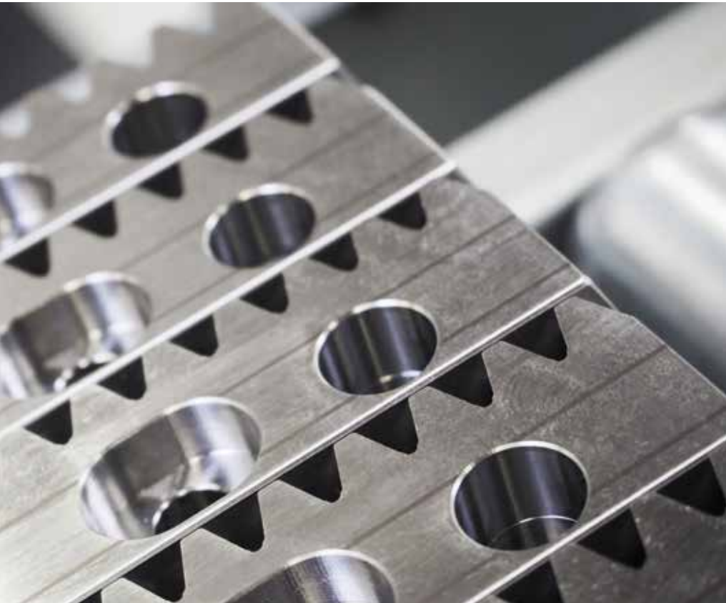
2 Zahnstangen nach der Bohrungs-Feinbearbeitung. Letztere erfolgt zeitminimiert, sind doch die Reibwerkzeuge einfach handhabbar und ermöglichen einen schnellen Schneidenwechsel ohne erneutes Einrichten (© Urma)
