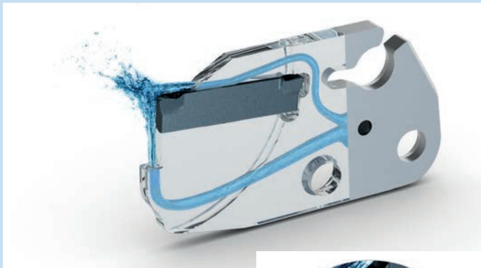
Beim ACS2 werden Schneid- und Freifläche gekühlt (oben). Kühlkanal trifft auf die Freifläche (rechts).
